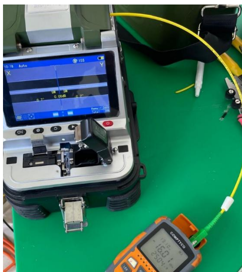
Figura 6.39 Medición de potencia en el domicilio (elaboración propia).
