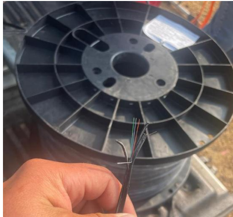
Figura 6.18 Fibra óptica drop 4 hilos figura 8 con mensajero (elaboración propia).
