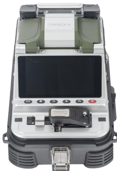
Figura 5.7 Fusionadora Ai-30 Linkedpro (Syscom, 2025).
