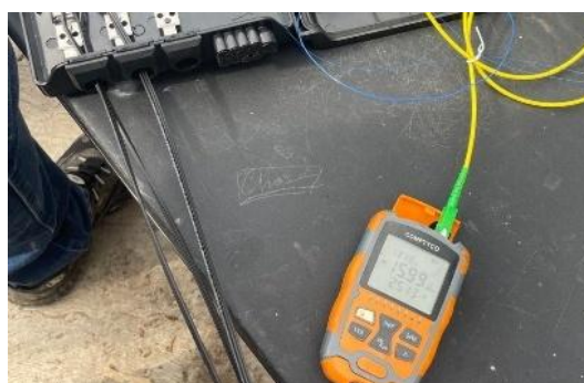
Figura 6.29 Potencia de la cuarta caja NAP (elaboración propia).
