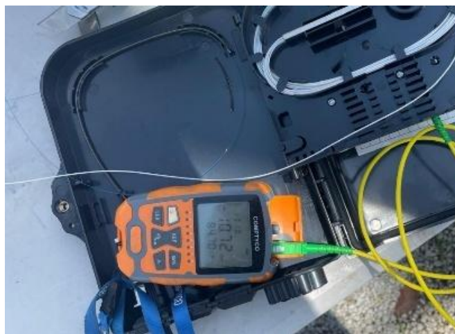
Figura 6.31 Potencia de la sexta caja NAP (elaboración propia).
